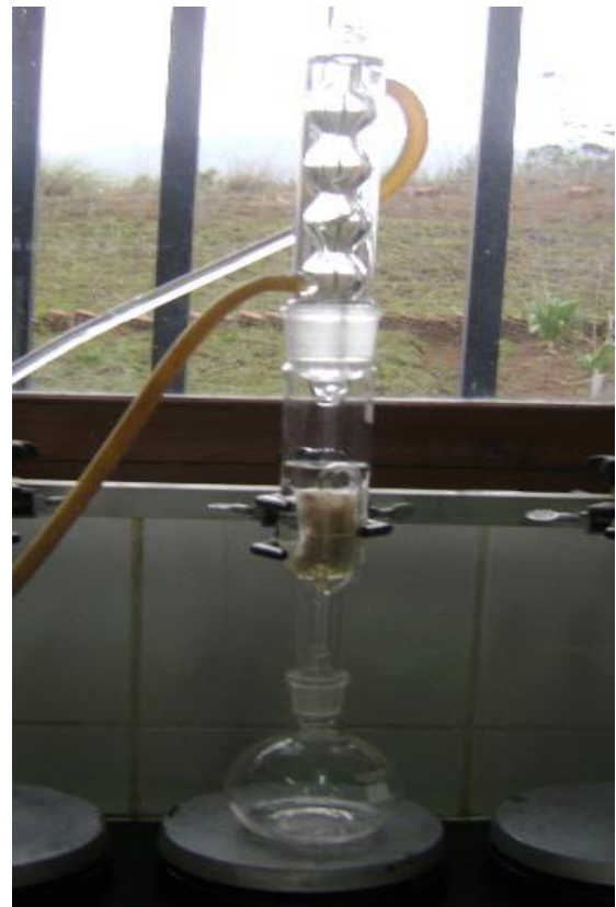
Imagen 04. Equipo soxhlet determinando el contenido de grasa.
