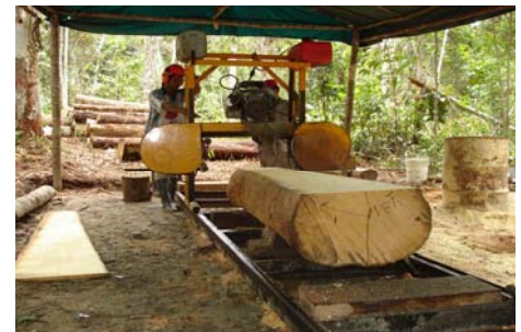
Fase de aserrío para determinar el rendimiento y calidad de la madera obtenida del raleo de plantaciones.
