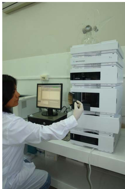
Capacidad de investigación de la mano con alta tecnología: Cromatógrafo líquido de alta eficiencia (HPLC)
