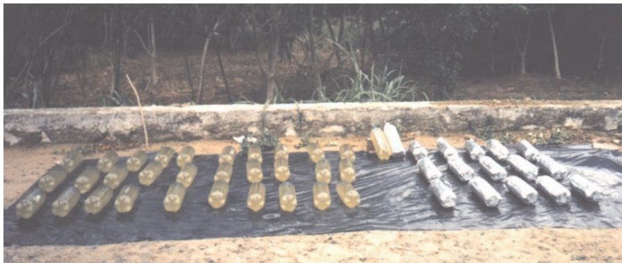
Figura 5. Montaje del experimento con las botellas completamente llenas de agua y expuestas directamente al sol (Ensayo S) y con las mismas envueltas en papel aluminio (Ensayo D). Figure 5. Experiment setup with the bottles completely filled with water and directly exposed to sunlight (S Test) and with bottles wrapped in aluminum foil (D Test).
