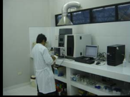
Análisis de calidad de agua mediante espectrofotometría de absorción atómica
