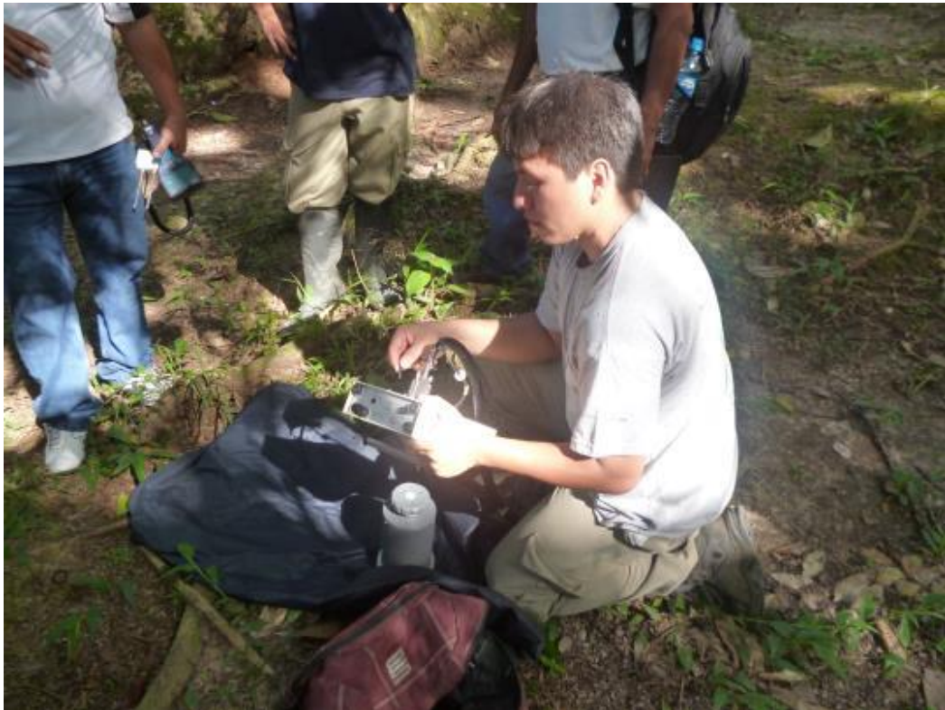
Foto: J. del Aguila © IIAP, prepración del dispositivo para la medición de la respiración de suelo.
