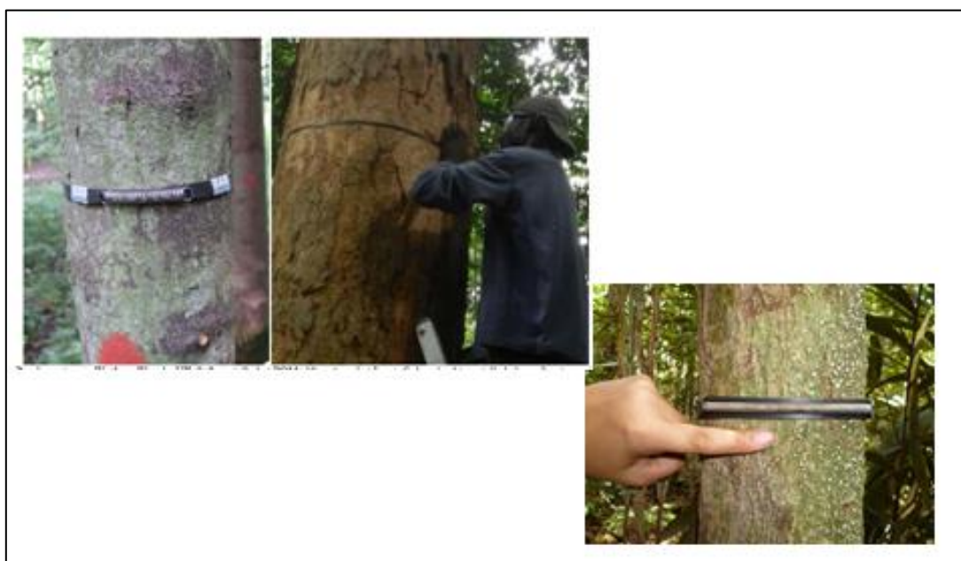
Figura 25. Dendrómetros instalados en árboles para evaluar los cambios en diámetro.
