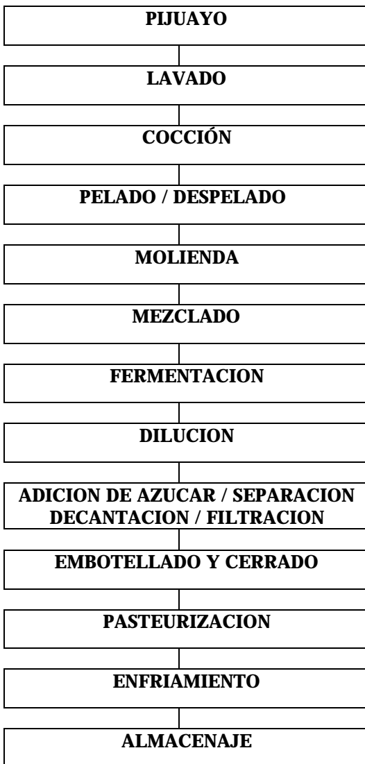
Fig. 1. Diagrama de flujo para el proceso de la bebida fermentada de Pijuayo ( Bactris gasipaes H.B.K.)
