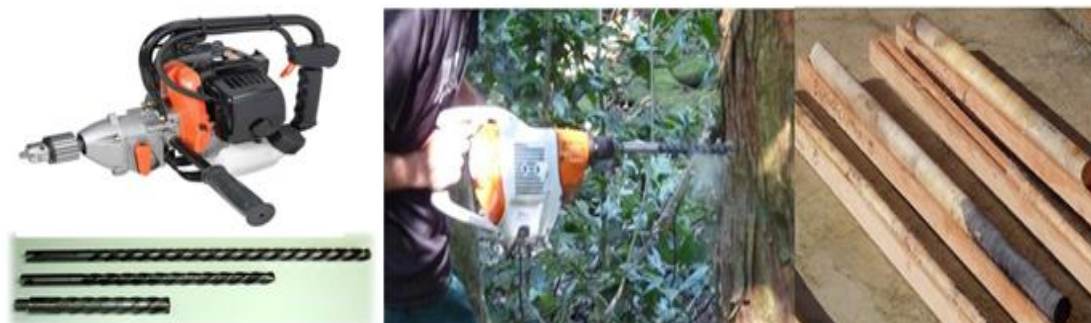
Figura 2. A. Sonda metálica corta acoplado a un extractor motorizado B. Extracción de las muestras de leño en árboles de Cedrelinga cateniformis . C. Detalle de muestra extraída por la sonda motorizada.
