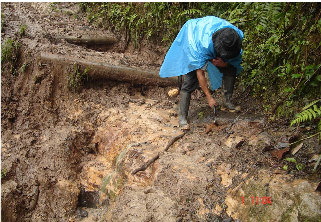
Foto 37: Niveles de arenisca pardo amarillenta limosa de grano fino a medio, laminares con presencia de óxidos paralelo a la estratificación. Margen izquierda del río Huamanpata (sector El Arenal), distrito de San Nicolás.
