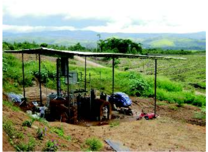
Foto 10. Microdestilería para la elaboración de etanol hidratado carburante AEHC de la empresa Riso Biocombustibles, San Martín.
