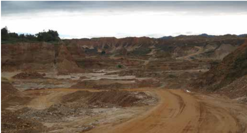
Foto 10: Remoción de la vegetación, suelo y subsuelo para la extracción del oro
